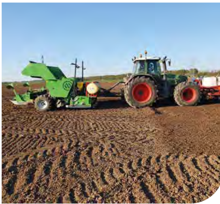
Het poten gebeurt in één werkgang, waarbij ook alle vloei- en meststoffen worden toegediend en de ruggen worden aangeaard
