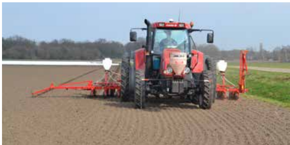
Zaaimachine met granulaat- en gerststrooier
